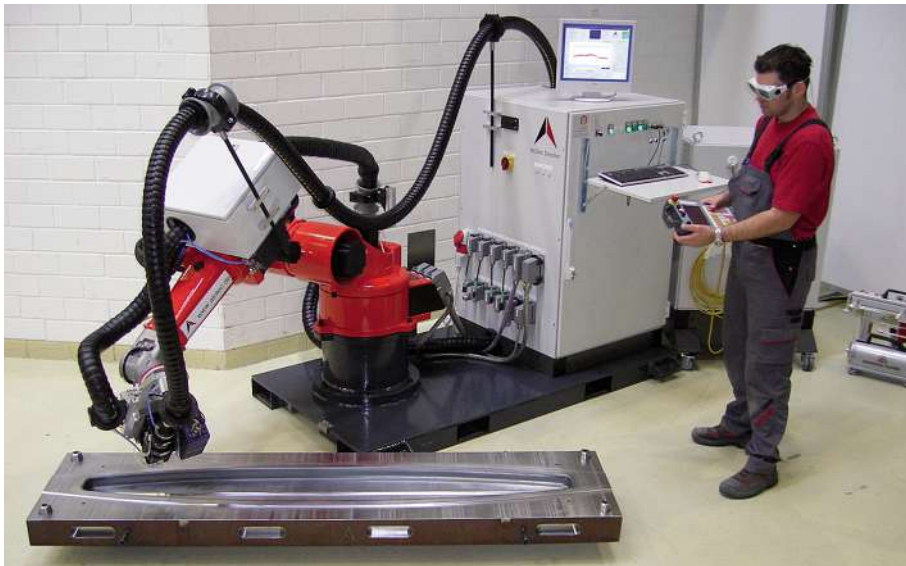
Bild 2: Mobile Härteanlage, die mit einem Hochleistungsdiodenlaser arbeitet. Sie eignet sich für Anwendungen direkt beim Kunden. Eine Erweiterung für das Pulver- und Drahtauftragschweißen ist möglich.
