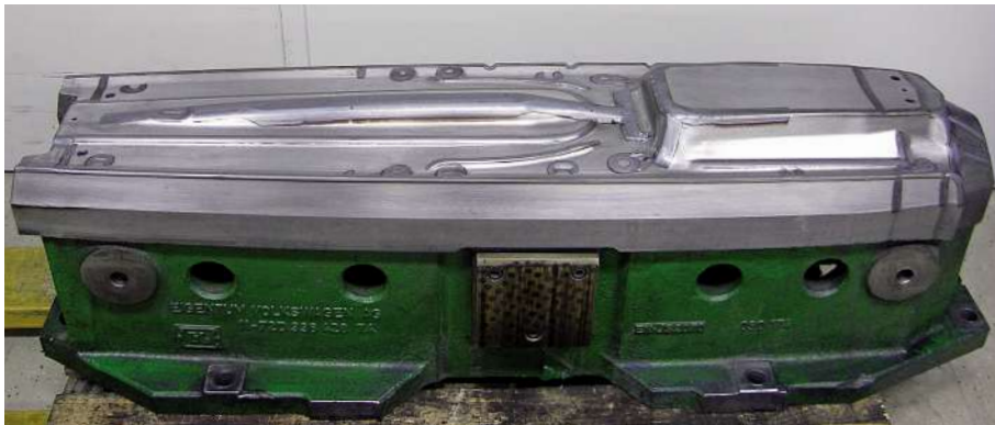
Bild 3: Bei diesem Werkzeugsegment wurden bestimmte 3D-Biegekanten partiell gehärtet. Die eingetragene Wärmemenge ist deutlich niedriger als bei anderen Verfahren.
