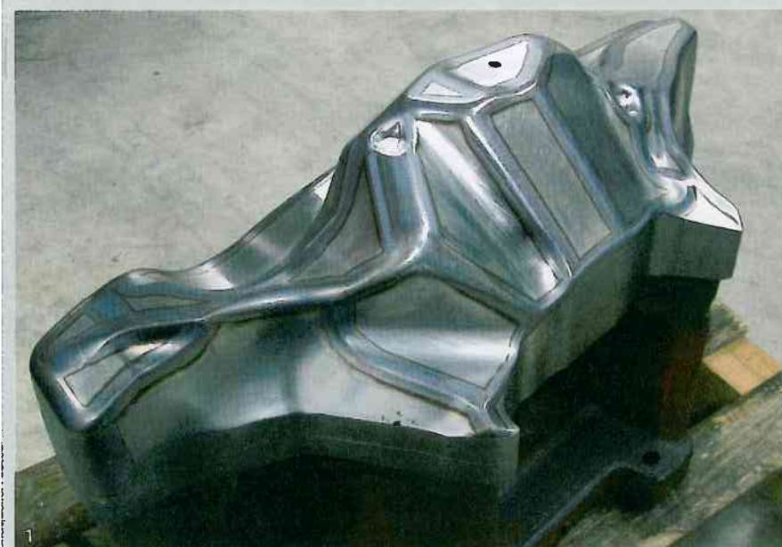
1 Der Laserstrahl ermöglicht das gezielte Härten bestimmter Bereiche 2 Die mehrachsige Kinematik erlaubt die ideale Ausrichtung des Laserkopfes auf fast jede Kontur 3 Die Laserhärteanlagen von Alotec lassen sich um die Funktionen Pulver- und Drahtauftragschweißen erweitern.
