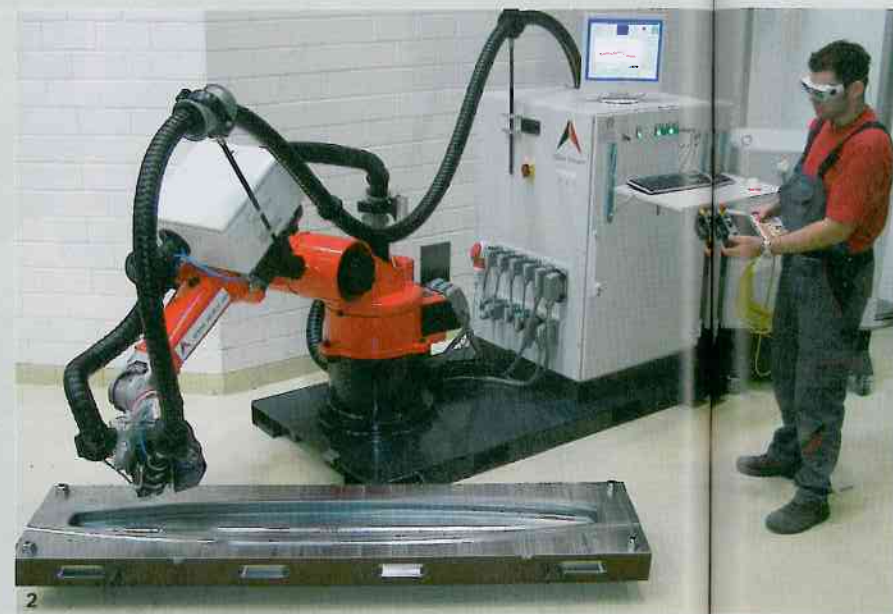
1 Der Laserstrahl ermöglicht das gezielte Härten bestimmter Bereiche 2 Die mehrachsige Kinematik erlaubt die ideale Ausrichtung des Laserkopfes auf fast jede Kontur 3 Die Laserhärteanlagen von Alotec lassen sich um die Funktionen Pulver- und Drahtauftragschweißen erweitern.
