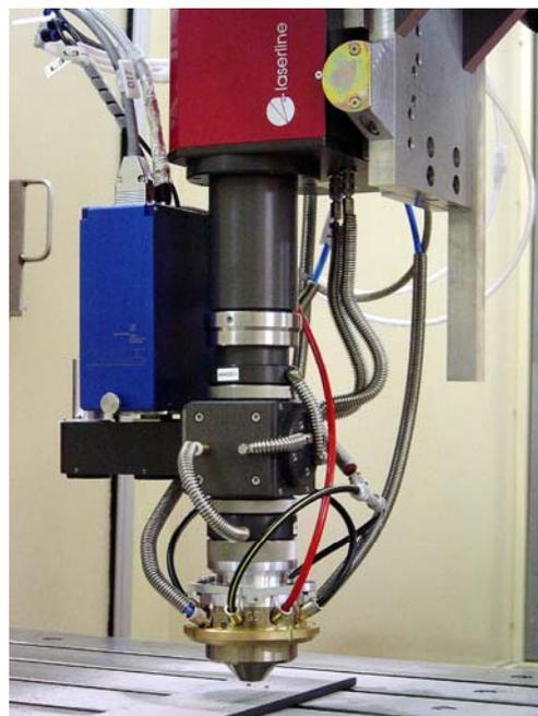
Il laser dispone per la tempra di diverse ottiche facilmente intercambiabili con distribuzioni lineari di densità per percorsi di tempra tra 5 e 20 mm di larghezza (con possibilità di arrivare fino a 50 mm con ottiche speciali). Per il riporto di polveri si utilizza invece un'ottica di saldatura con distribuzione puntiforme di intensità.
