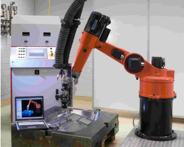
Figura 3: dettaglio della testa laser e del robot antropomorfo presenti nell'impianto
