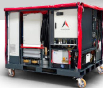
Mobile Station für Lasermodul, Kühlung, Pulverförderer, Energiekette und Schaltschränke
