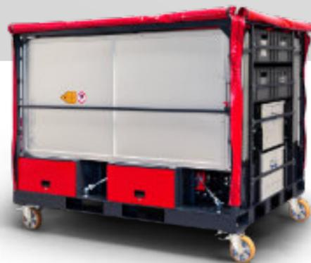
Mobile Station für Laserschutzwände, Roboter mit Raupenfahrwerk, Zubehör und Werkzeug
