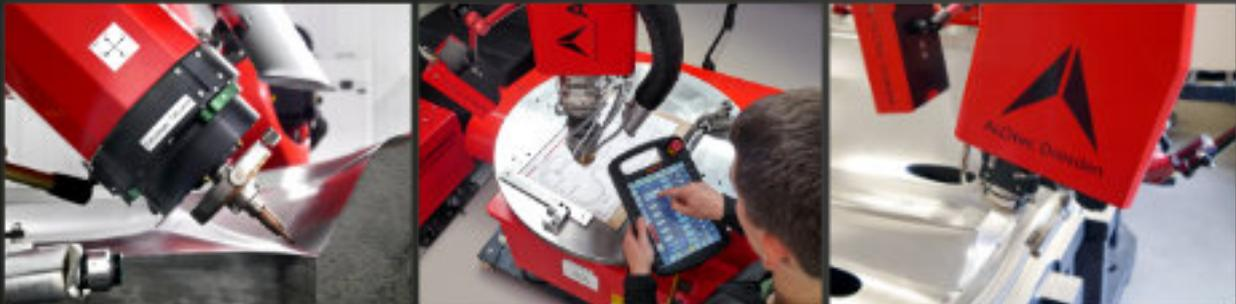
Darüber hinaus bietet die **ALOtec Dresden GmbH** Dienstleistungen in den Bereichen Laserhärten und Laserauftragschweißen mit Pulver oder Draht an. Diese Lasermaterialbearbeitung kann auch – durch das innovative **ALOflex**-System – vor Ort beim Kunden erfolgen.
