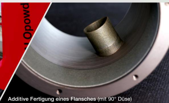
Additive Fertigung eines Flansches (mit 90° Düse)
